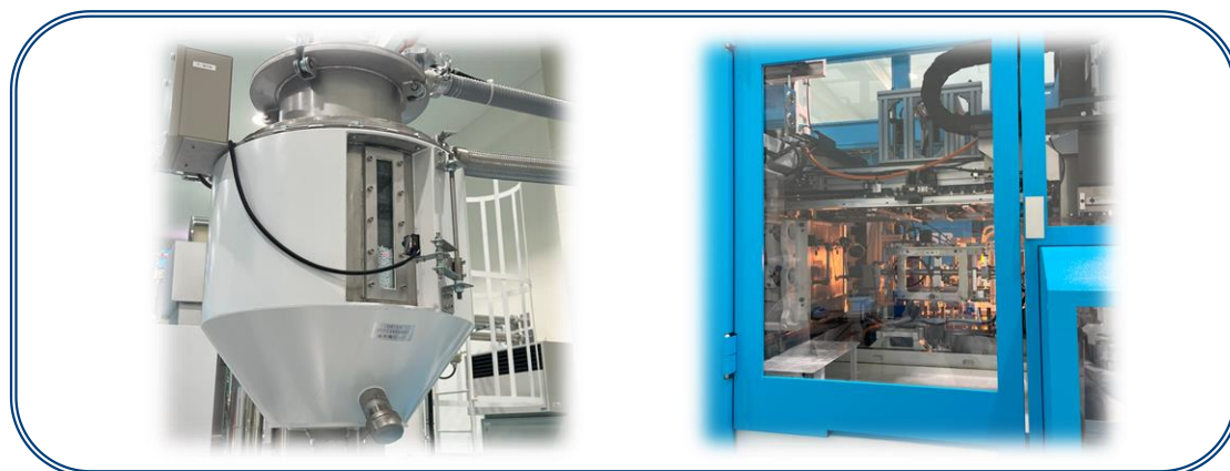
原料のペレット材から PETボトルの成形までを、1台の機械で全て対応。
